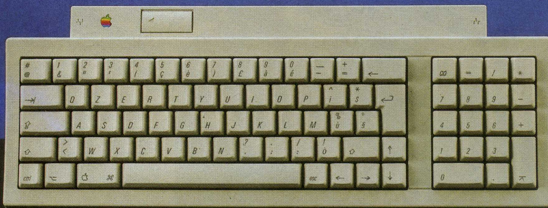
La tastiera fornita in dotazione ricorda quella dell'Apple IIGS, si noti il tasto di reset che in combinazione con altri tasti può sostituire i «tasti programmatore».
